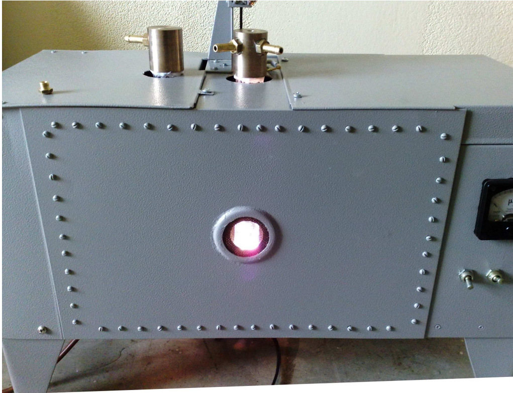
Экспериментальная масштабируемая установка высокотемпературной плазменной обработки волокна (Изготовлена в ходе работ в интересах ОДО ТХФ, РБ, Минск).
